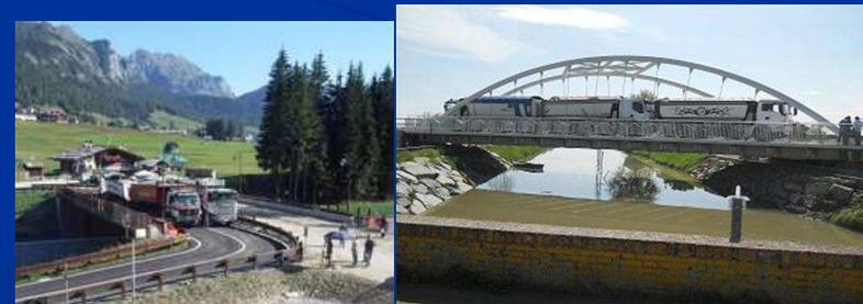
Prova di carico con autocarri
