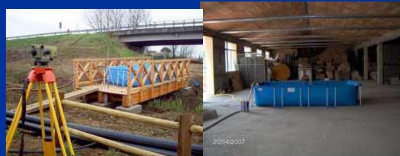
Prova di carico con carico distribuito
