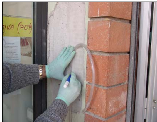
Esecuzione delle letture ultrasoniche.
