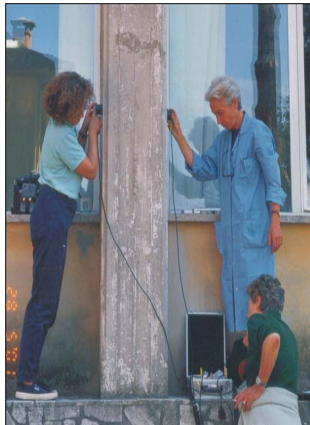
Esecuzione delle letture ultrasoniche.
